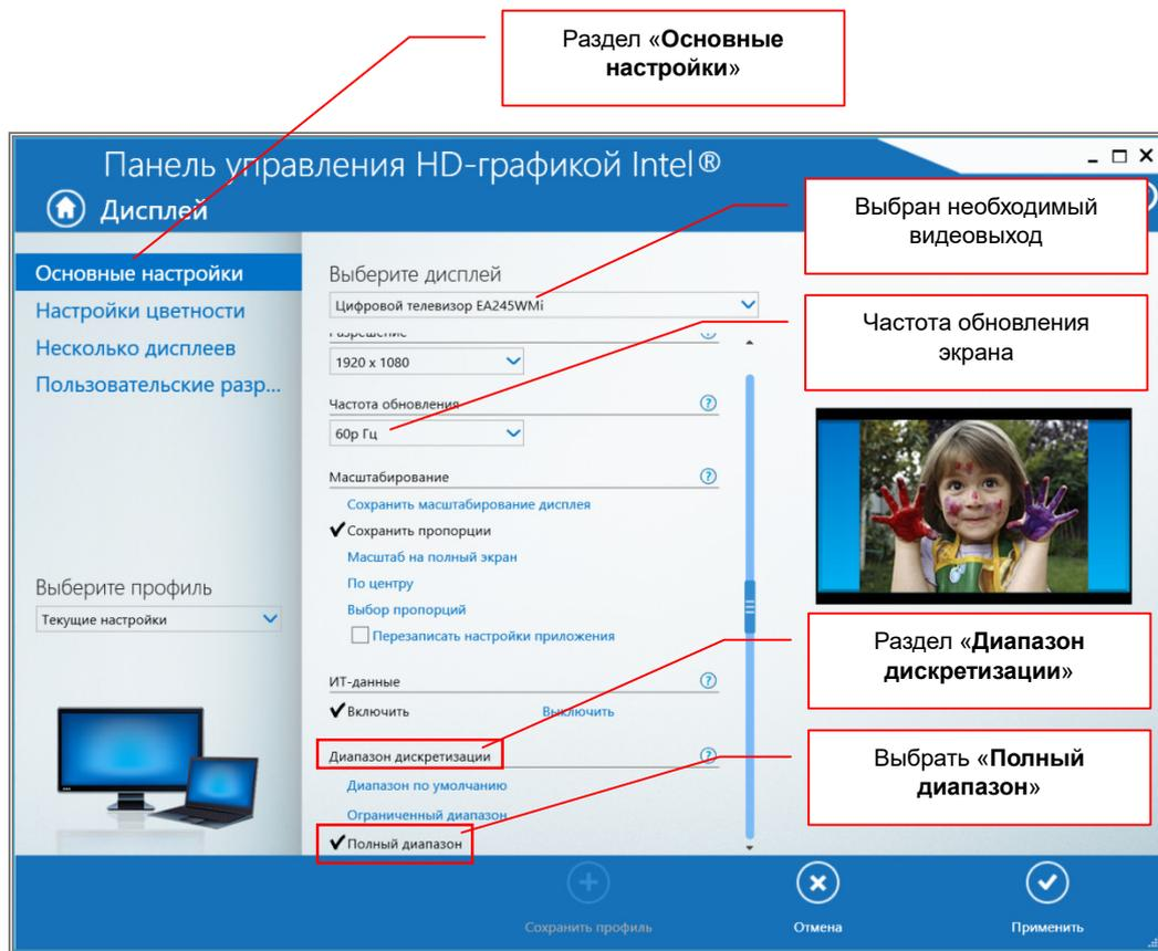
Еще одним важным параметром, является масштабирование изображения на экране. Разрешение, которое установлено пользователем, не всегда может совпадать пропорциями сторон с пропорциями устройства отображения, на котором транслируется изображение.
