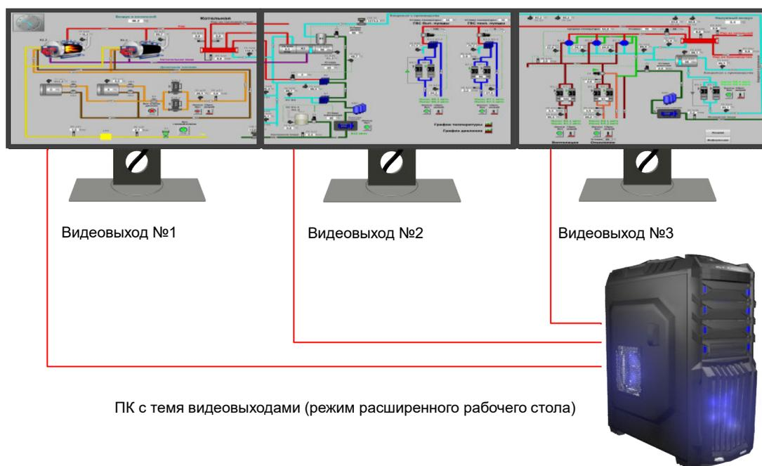
К IP-KVM системе, многомониторный источник подключается при помощи IP-KVM передатчиков, количество которых соответствует количеству видеовыходов подключаемого компьютера (устройства).
