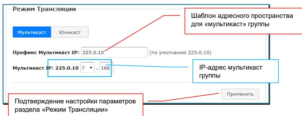
**Важно!** У передатчика и всех приемников, подключаемых к нему, должен быть одинаковый префикс IP-адреса мультикаст группы, в противном случае они не будут видеть друг друга.
