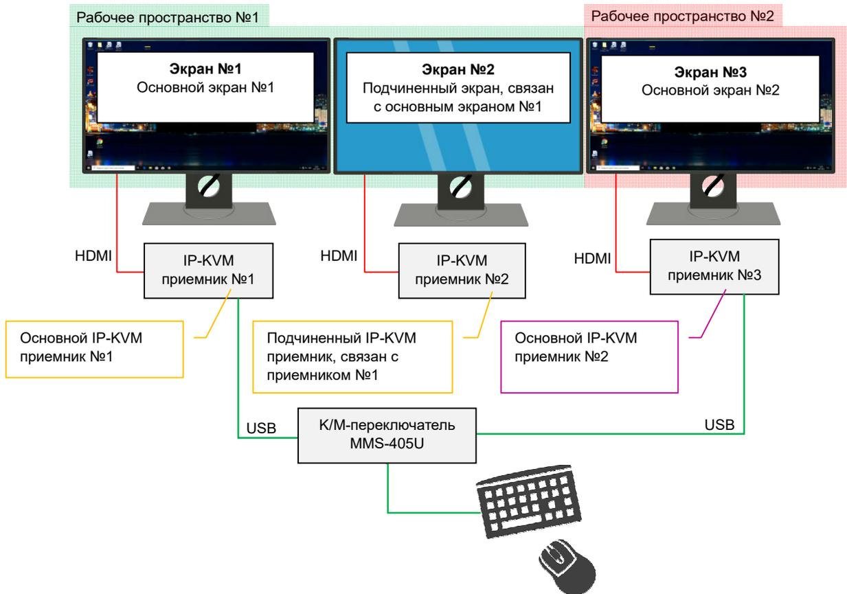
Пример сложного многомониторного рабочего места с тремя рабочими пространствами и одним основным экраном. Авторизация возможна на экране №1, выбор источников на экранах №1, №2 и №3.
