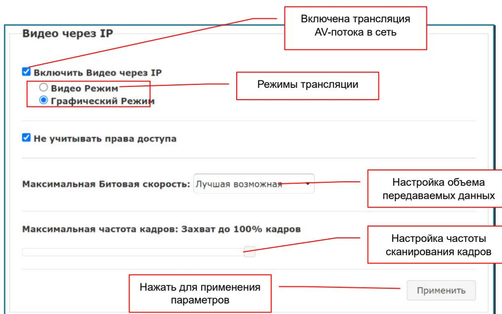
«Включить Видео через IP» — включение/выключение трансляции AV-потока в локальную сеть, по умолчанию включено.
