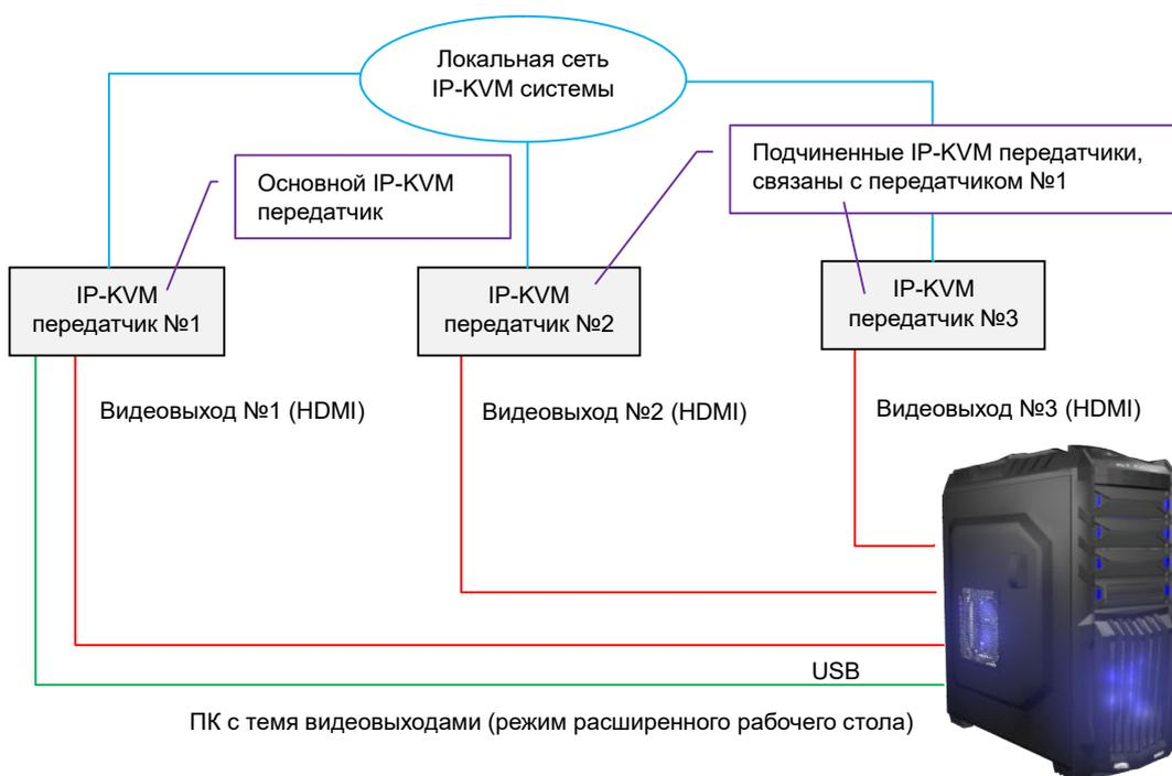
**Важно!** В данной схеме, основные IP-KVM передатчики, имеют USB подключение к управляемому источнику, а подчиненные (связанные) IP-KVM передатчики, USB подключения к источнику **не имеют**.
