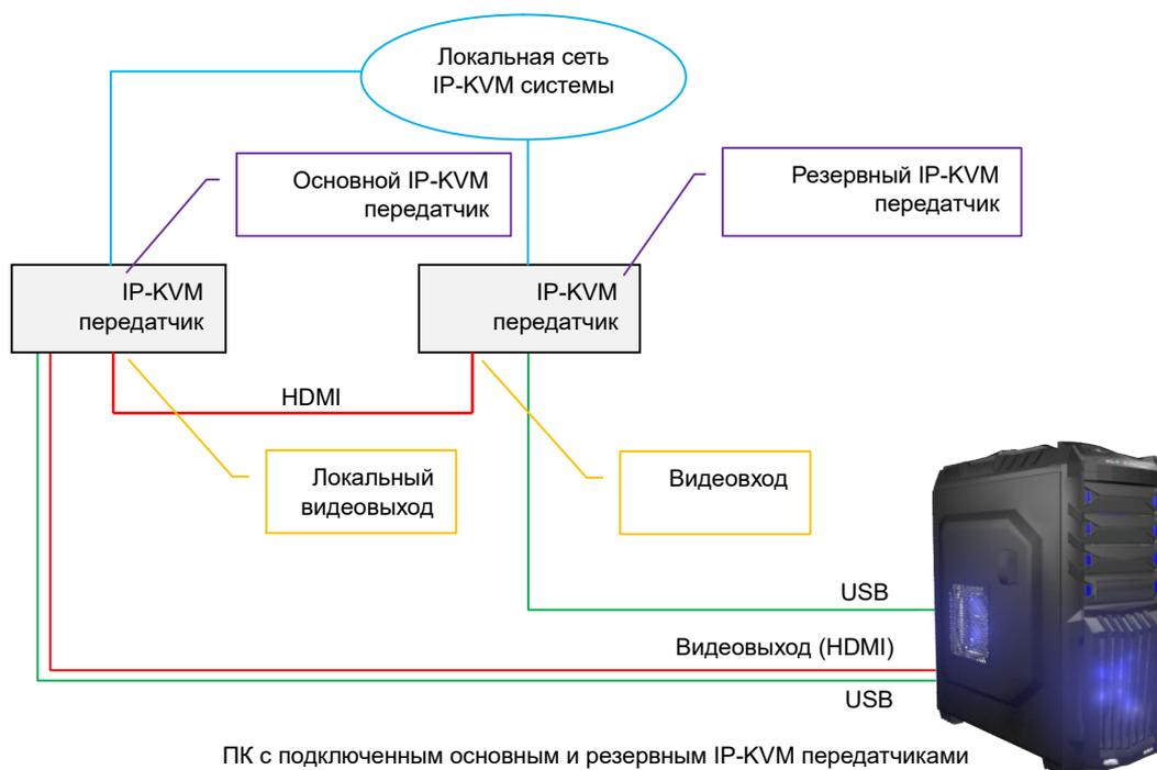
ПК с подключенным основным и резервным IP-KVM передатчиками
