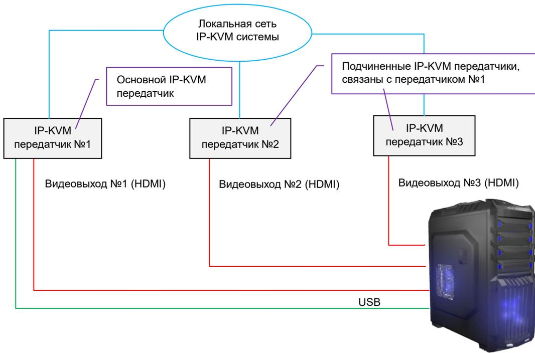
Подключение и настройка многомониторного источника к IP-KVM системе с тремя основными передатчиками
