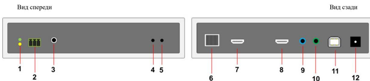
1. Индикатор питания и состояния устройства (зеленый), индикатор сетевого соединения (желтый)
