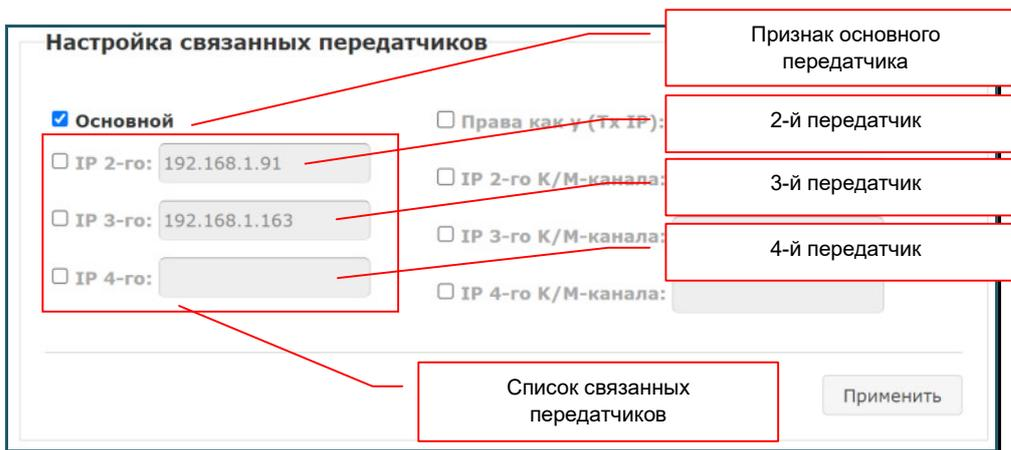
По умолчанию, параметр «Основной», активирован у всех IP-KVM передатчиков. В случае с многомониторным источником, такие настройки являются **не корректными**. Параметр «Основной», должен быть включен только у IP-KVM передатчика, который подключен к «основному экрану», у остальных передатчиков, этот параметр должен быть **отключен**.
