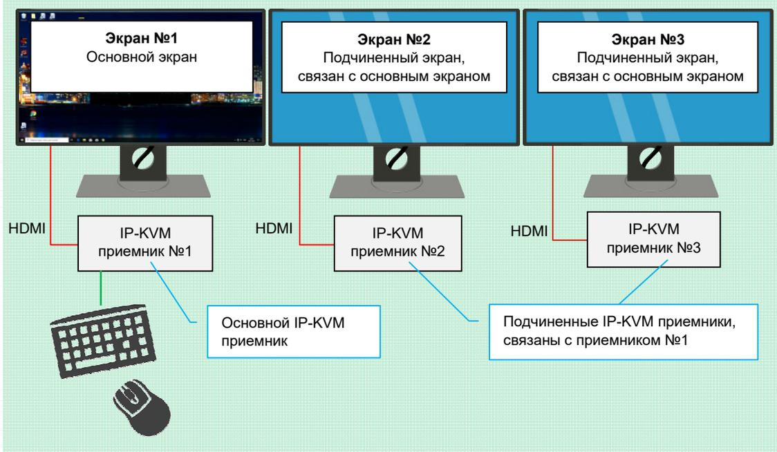
**Важно!** Один основной экран и связанные с ним экраны образуют **одно рабочее пространство**. Минимальный состав рабочего пространства – один основной экран. У одного основного экрана может быть до **трех**, подчиненных (непосредственно связанных с ним) экранов. Каждый экран рабочего места, должен принадлежать только одному рабочему пространству.
