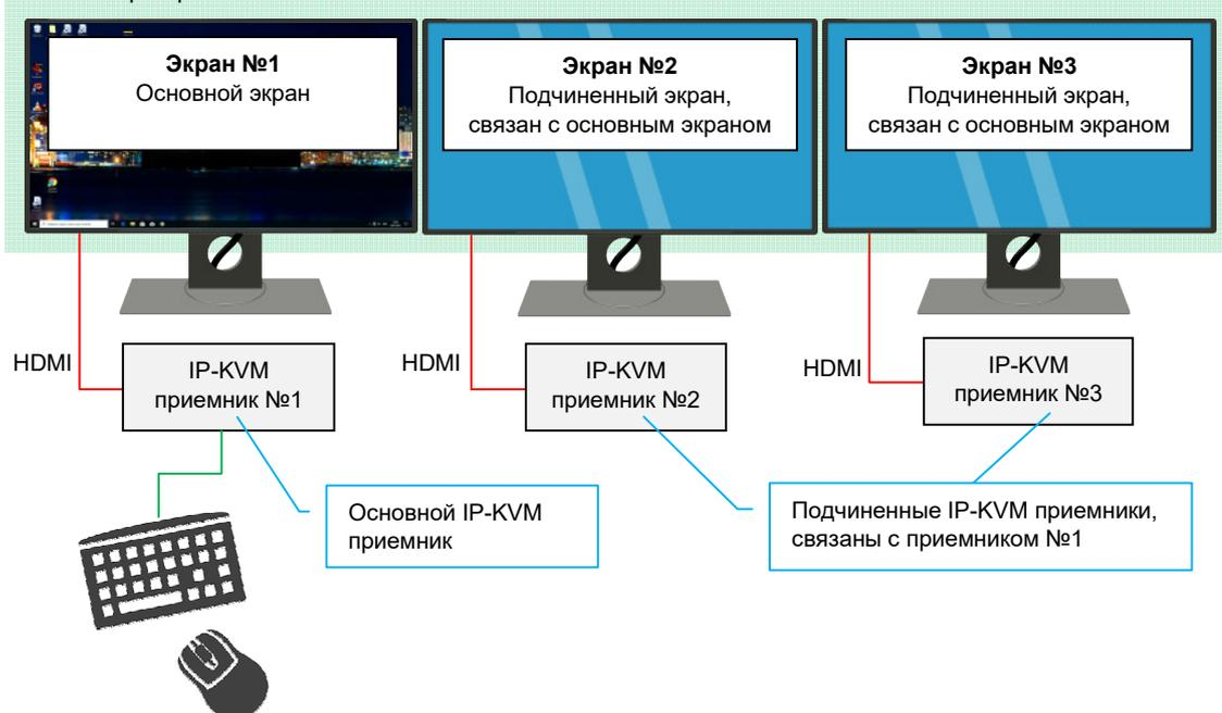
**Для информации.** Рекомендуется настроить IP-KVM систему таким образом, чтобы на многомониторном рабочем месте, оператор мог выбирать только те источники, у которых количество видеовыходов не превышает количество мониторов на рабочем месте оператора. Ограничение по типу источников (в том числе и по количеству видеовыходов) доступных для выбора оператора, настраивается при помощи фильтров.
