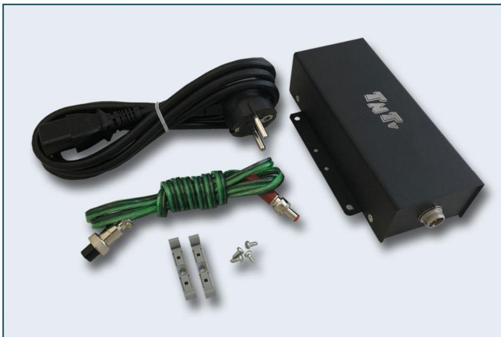
Для обеспечения бесперебойного электропитания IP-KVM передатчиков и приемников серии MMS-95xx рекомендуется использовать двухканальный коммутатор питания TNT КП-21, который обеспечивает бесперебойное питание подключенной нагрузки от двух блоков питания TNTv БПИС М8 12-2. При выходе из строя одного из блоков питания, автоматически подключается второй блок питания, без отключения питаемой нагрузки.
