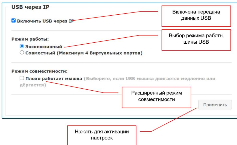
Передатчик имеет два режима работы с данными USB:
