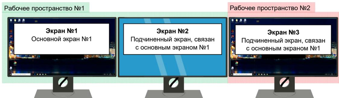
Пример двух рабочих пространств, с двумя основными экранами
