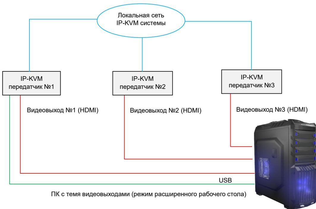
К каждому IP-KVM передатчику подключается свой видеовыход компьютера. К одному из IP-KVM передатчиков (основному) подключается USB-интерфейс от компьютера.
