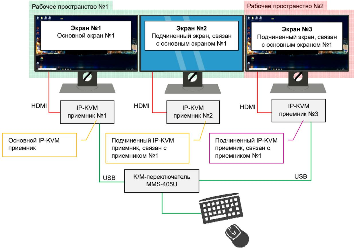
Пример сложного многомониторного рабочего места с двумя рабочими пространствами и двумя основными экранами. Авторизация и выбор источников возможна на экранах №1 и №3.
