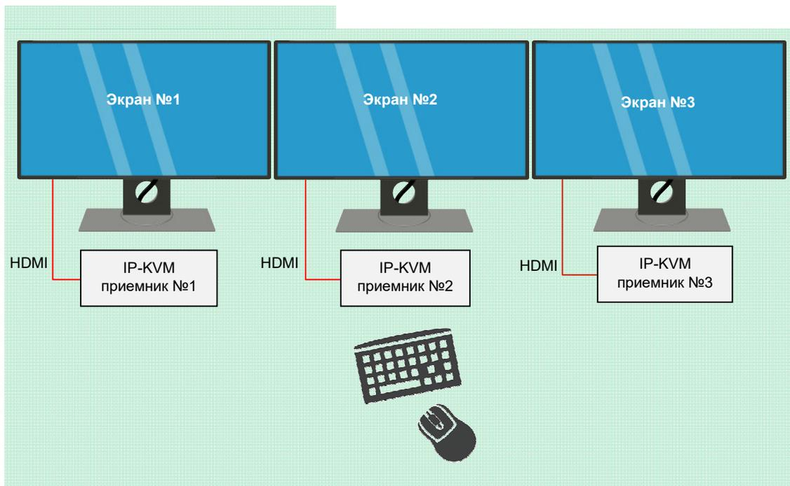
**Важно!** Основные IP-KVM передатчики, отображаются в экранном меню IP-KVM приемников и они доступны оператору для выбора. Подчиненные (связанные) IP-KVM передатчики не отображаются в экранном меню IP-KVM приемников и они **не доступны** оператору для выбора. Подчиненные (связанные) IP-KVM передатчики подключаются к IP-KVM приемникам только автоматически, при выборе оператором основного IP-KVM передатчика.
