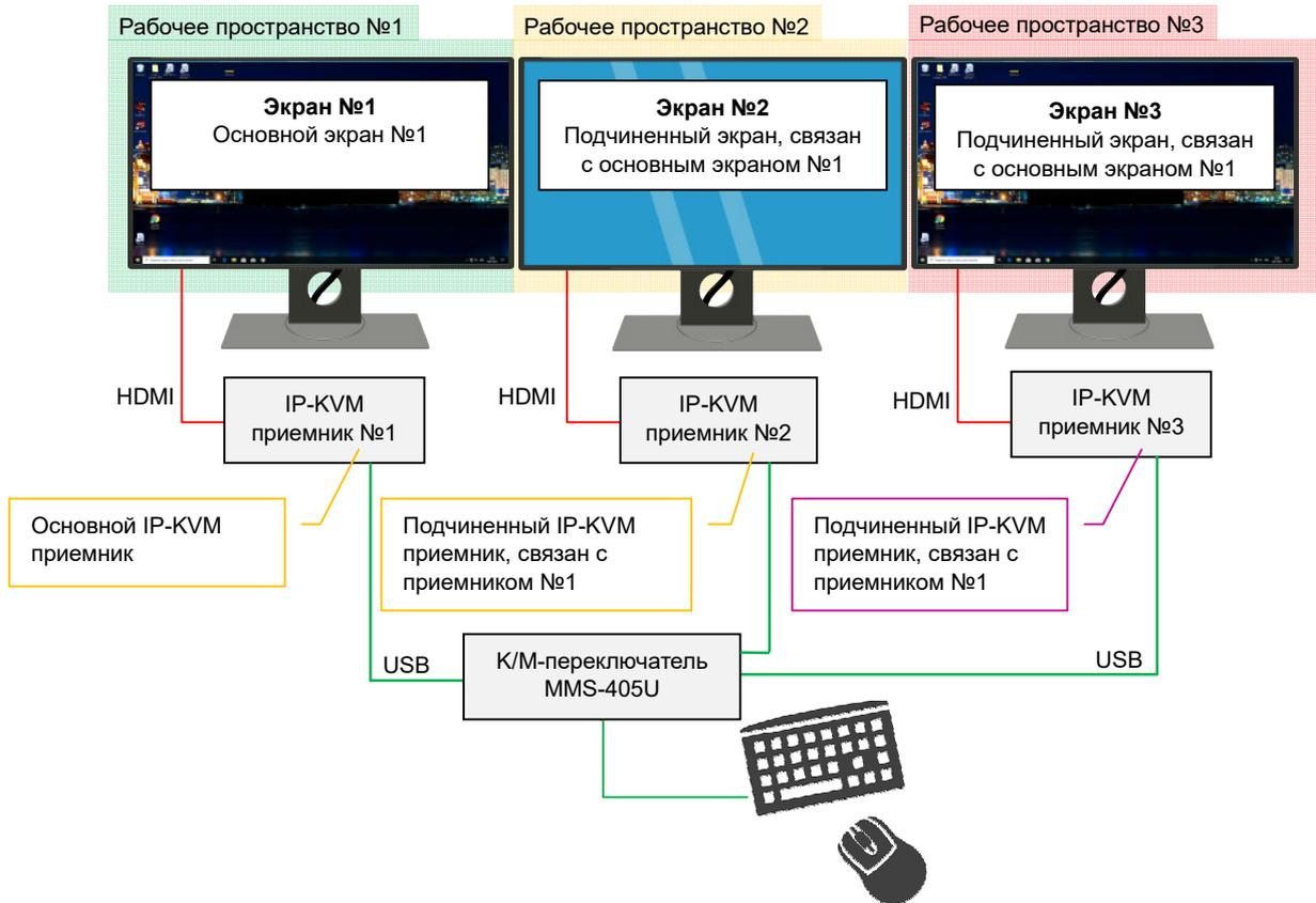
**Для информации.** На сложном многомониторном рабочем месте, выбор источников для каждого рабочего пространства, осуществляется оператором в произвольном порядке.
