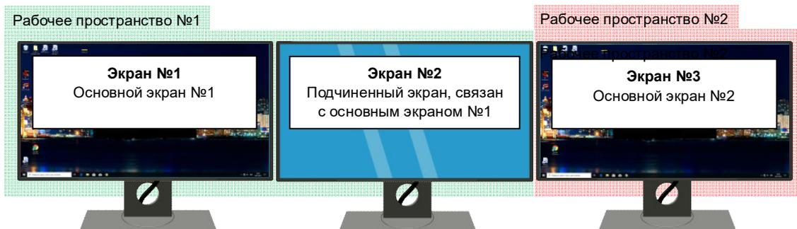
Пример сложного многомониторного рабочего места с двумя рабочими пространствами и одним основным экраном. Авторизация возможна на экране №1, выбор источников на экранах №1 и №3.
