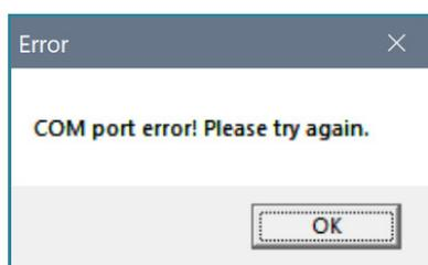
Проверьте правильность настройки коммуникационного порта и соединение компьютера и USB КМ-коммутатора, после чего повторите попытку записи данных.
