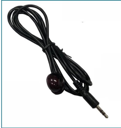
**Для информации.** Комплект поставки включает 4 внешних индикатора активного порта. Выносной индикатор – светодиод в корпусе, установленный на шнуре длиной 1.5 метра, который дублирует соответствующий индикатор активного порта, встроенный в USB-переключатель. Корпус индикатора имеет самоклеящуюся основу для крепления на поверхности.
