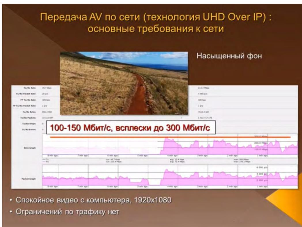
А вот уже потребление полосы пропускания при передаче UHD сигнала.
